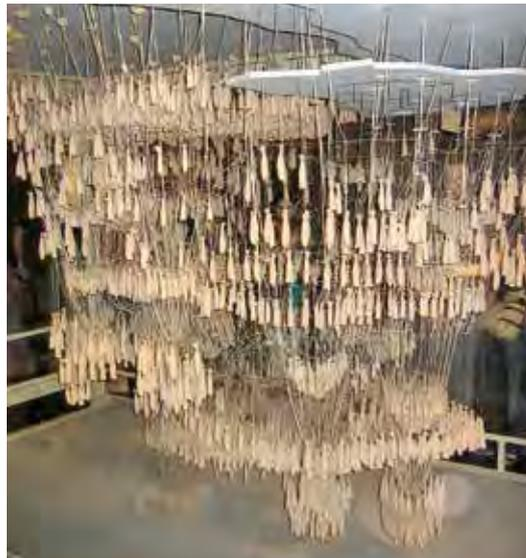
Diesen Trick nutzte auch der spanische Architekt **Antoni Gaudi** für die Konstruktion seiner berühmten Kirche Sagrada Família in Barcelona: Er baute ein Kettenmodell, um die Statik für diese Kirche zu berechnen.
